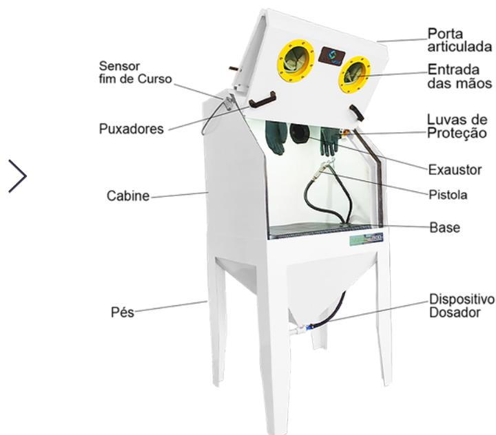
Cabine de Jateamento Modelo ALPHA 800 desenvolvida para limpeza de superfícies que necessitam de tratamento especial antes da manutenção, montagem e pintura. Com aspecto inovador e moderno proporciona uma alta performance durante operação, segurança, rendimento e redução de custos.
